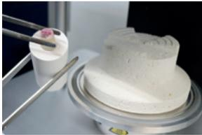
Die VINTAGE PRIME PRESS Rohlinge so in die heiße Muffel füllen, dass der Farbaufdruck oben liegt.
