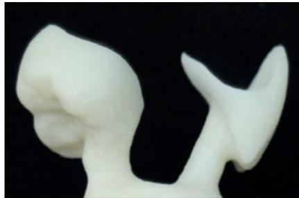
Vollständig ausbettete Objekte nach der Feinausbettung mit Aluminiumoxid ( $\text{Al}_2\text{O}_3$ ) bei einem Druck von ca. 0,2-0,3 MPa (2-3 bar).
