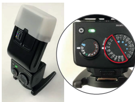
Nella modalità SF di Nissin Digital i40, l'intensità della luce può essere regolata manualmente tramite la manopola di regolazione.
