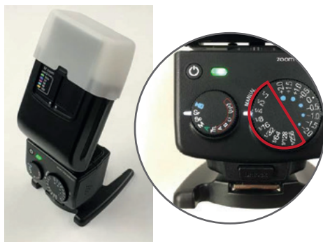
Im SF-Modus des Nissin Digital i40 kann die Lichtintensität manuell über den Drehregler eingestellt werden.
