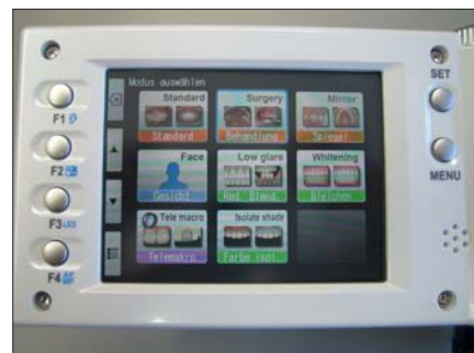
Die Kamerarückseite im Detail zeigt das Display mit Touchscreen und die übersichtlich angeordneten Druckknopf-Tasten.
