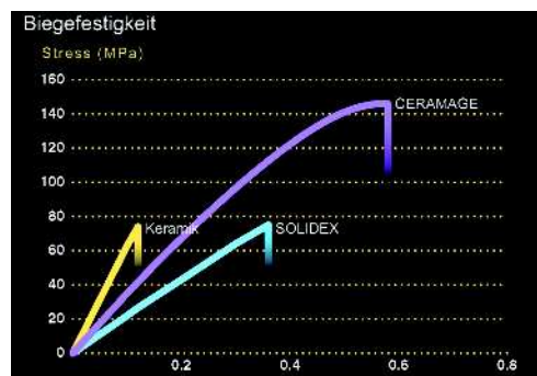
Abb. 3: Biegefestigkeit von Ceramage im Verhältnis zu Solidex und Keramik.
