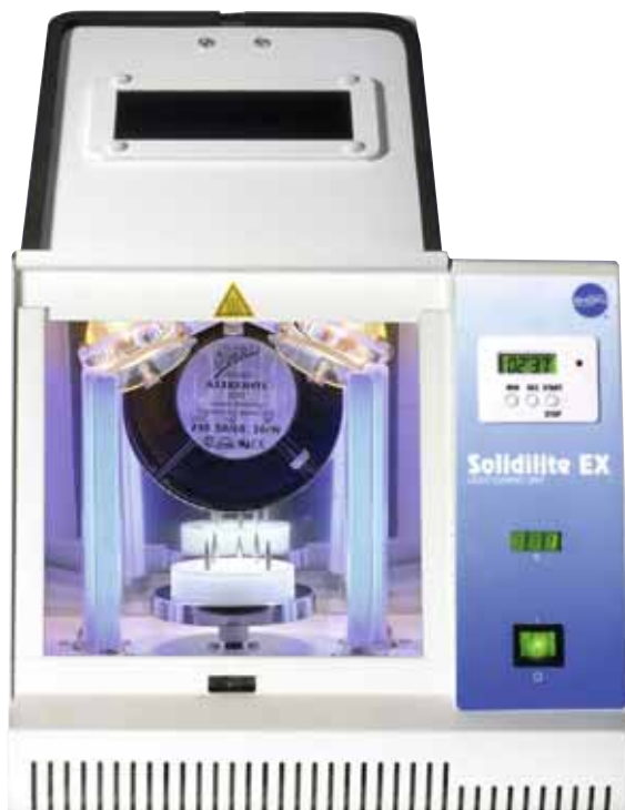
Abb. 4 Die Belichtungskammer des Solidilite EX ist optimal gestaltet. Neben zwei leistungsstarken Halogenstrahlern und vier UV-Kaltlichtröhren erhöht eine verspiegelte Polymerisationskammer die Polymerisationstiefe der Komposite bei kurzer Belichtungszeit. Ein Objektdrehsteller sorgt für eine schattenfreie Beleuchtung der zu polymerisierenden Objekte
