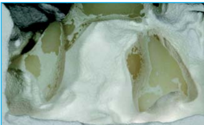
Abb. 4: Vereinfacht gilt: Je heißer die Einbettmasse, desto stärker die Reaktionsschicht. Da eine Muffel im Kern stets kälter als an der Außenwand ist, ist die Ausbildung der Reaktionsschicht dort geringer.
