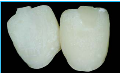
Abb. 5: Reaktionsschicht mit einer Standard-Einbettmasse
