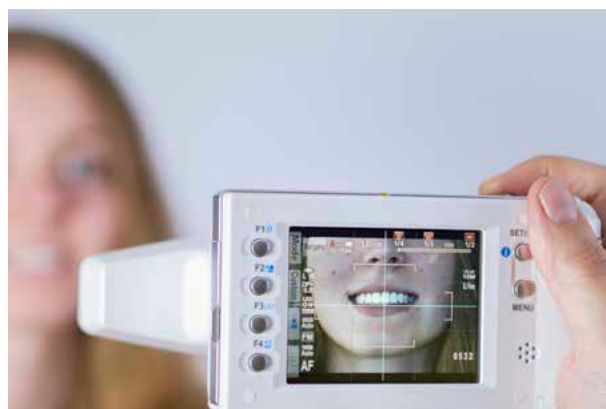
Afb. 2: Dankzij zijn geringe gewicht, de trefzekere autofocusfunctie en een optisch stabiliseringsprogramma is de EyeSpecial C-III ook met één hand te bedienen.
