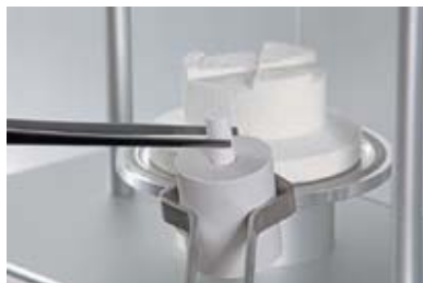
Inserire poi il pistone monouso nel cilindro riscaldato.
