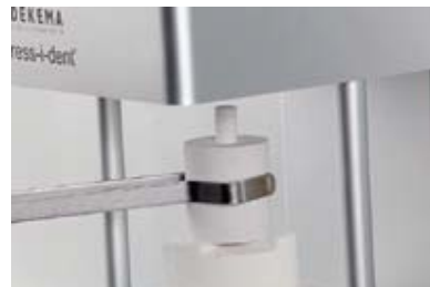
Posizionare il cilindro da rivestimento completo al centro del forno di pressatura preriscaldato.
