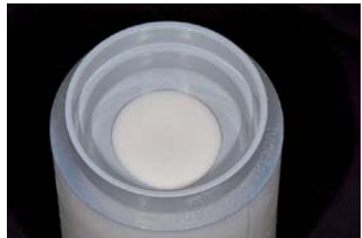
Posizionare il coperchio sul cilindro, in modo che la superficie superiore e il fondo del cilindro risultino paralleli.
