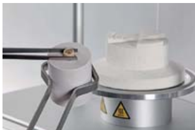
Inserire nel cilindro riscaldato il pellet VINTAGE LD PRESS con la stampigliatura del colore rivolta verso l'alto.
