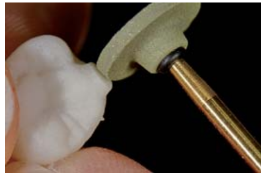
Rifinire le sbavature residue della separazione dei perni di colata con Dura-Green DIA.
