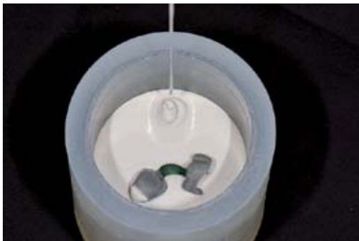
Evitare la formazione di bolle d'aria quando si versa il rivestimento nel cilindro.
