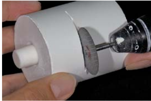
Tagliare il rivestimento con un disco separatore.
