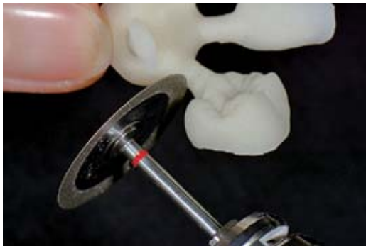
Tagliare i canali di colata usando un disco diamantato fine a bassa velocità.
