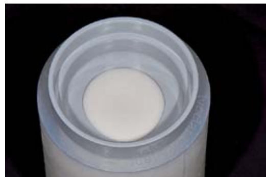
Plaats de deksel op de moffel, zodat de boven en onderkant parallel ten opzichte van elkaar blijven.
