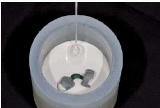
Voorkom insluiting van luchtballen bij het vullen van het inbedmateriaal in de moffel.
