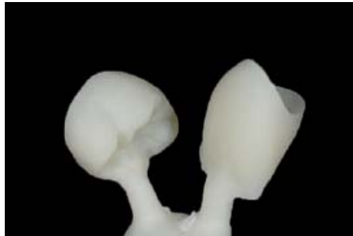
Volledig uitgebedde voorwerpen na fijn uitbedden met \text{Al}_2\text{O}_3 bij een druk van ong. 0,1-0,2 MPa (1-2 bar).
