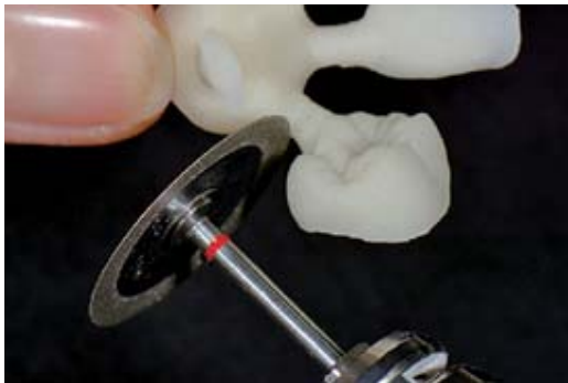
Gebruik fijne diamantschijven met lage snelheid om de perskanalen door te snijden.
